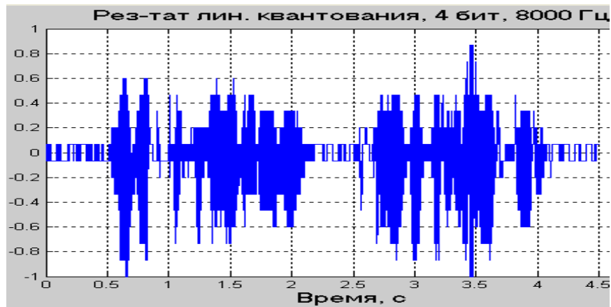
Рис. 16. Результат линейного 4-битного квантования реального сигнала
