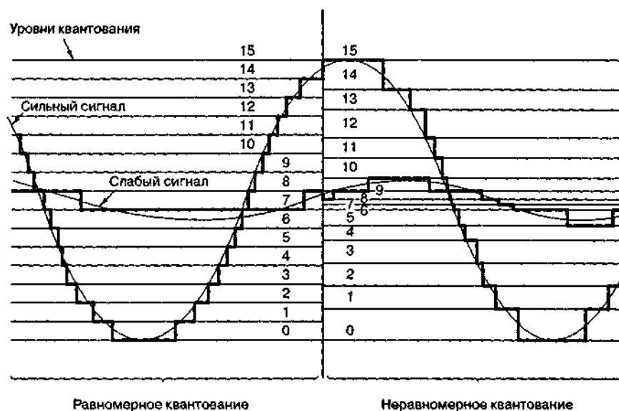
Рис. 3. Равномерное и неравномерное квантование сигналов
